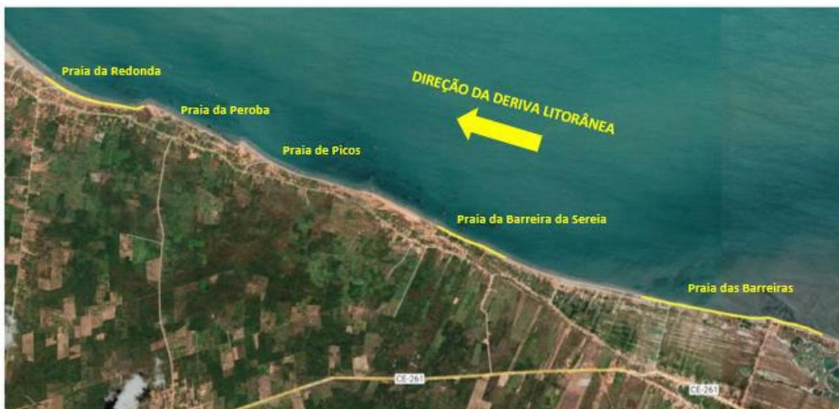
**Figura 2** – Localização das praias, com a contenção erosiva do tipo enrocamento. A linha amarela delimita os locais com presença dos muros de pedra (definição local).
