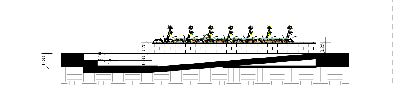
CORTE CC - DET. RAMPA ESCALA: 1:50
