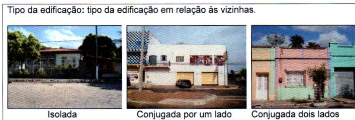
Figura 16: Exemplo de tipos de edificações
