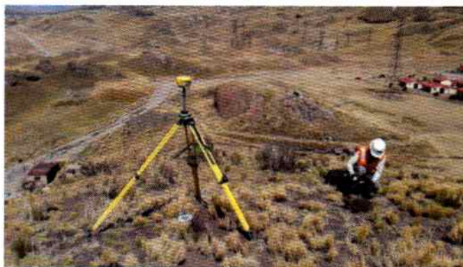
Figura 3: Uso de Receptores GNSS de Dupla Frequência
